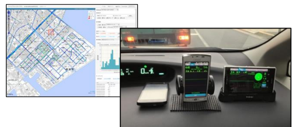
走るだけで路面状態が計測できる「BumpRecorder」
