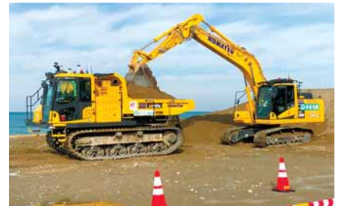
自動施工・遠隔施工のイメージ (写真左が自動施工車両、右が遠隔施工)
